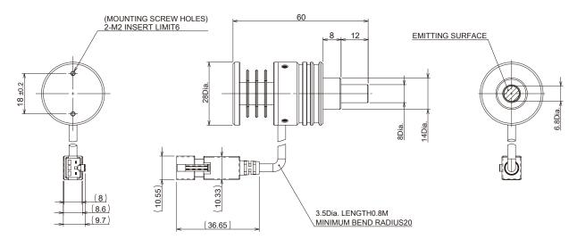
Tightening torque: 0.15N · m
