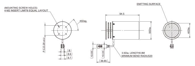
Tightening torque: 0.15N · m
